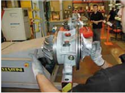
HOHE VARIABILITÄT DANK EINER NEUEN MONTAGEVORRICHTUNG FÜR TURBOLADER TPS44-F.
